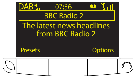
Die kontextsensitiven Tasten, mit zwei Bildschirmoptionen, Voreinstellungen und Optionen
